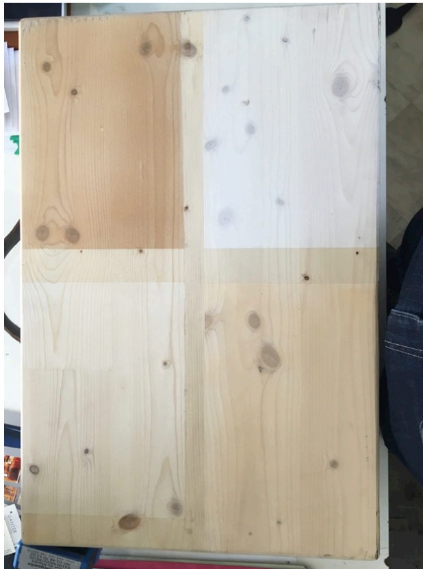
Photo 5 : Exemples d'aspects tons transparents en TEKNOSAFE 2467 FR
