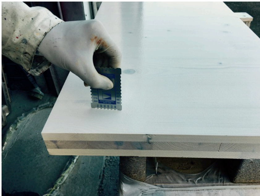
Photo 1 : Jauge d'épaisseur humide sur TEKNOSAFE 2467 humide
